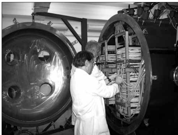
Obr. 4: Zapojení konektoru topných dlaždic
