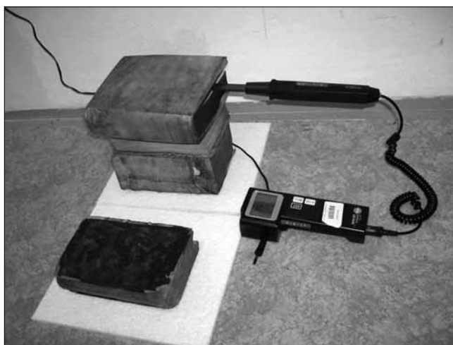
Obr. 8: Kontrola vlhkosti po usušení
