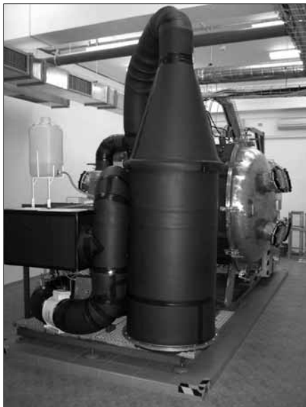
Obr. 1: Celkový pohled na víceúčelovou vakuovou komoru
